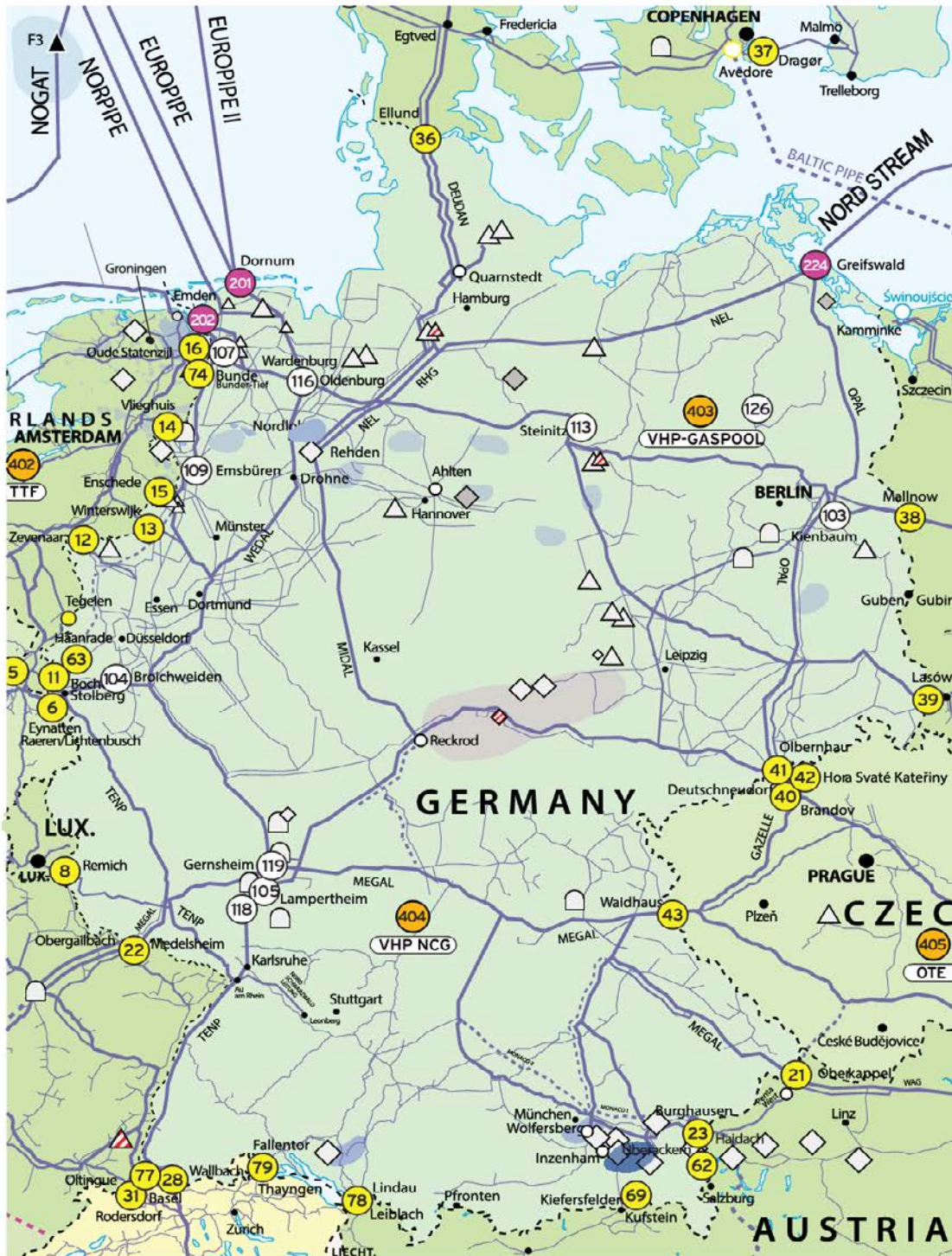
Abbildung 1: Das deutsche Fernleitungsnetz und seine Einbindung in die europäische Transportinfrastruktur
